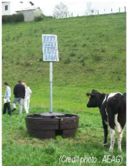
(Crédit photo : AEAG) Abreuvement avec pompe à panneaux solaires
