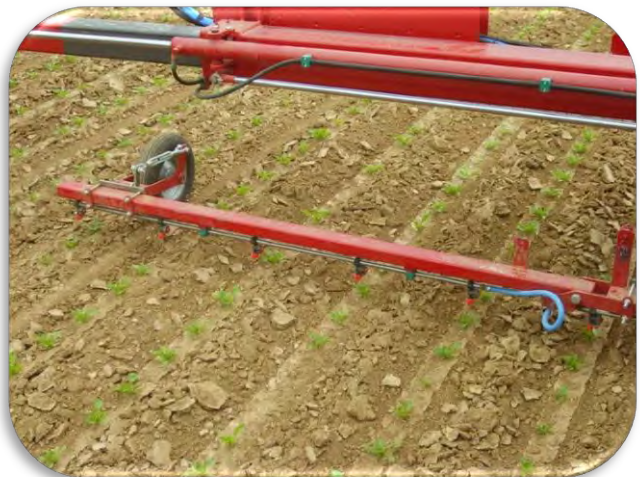
Exemple rampe spécifique de désherbage sur le rang de la société SOPEMA
